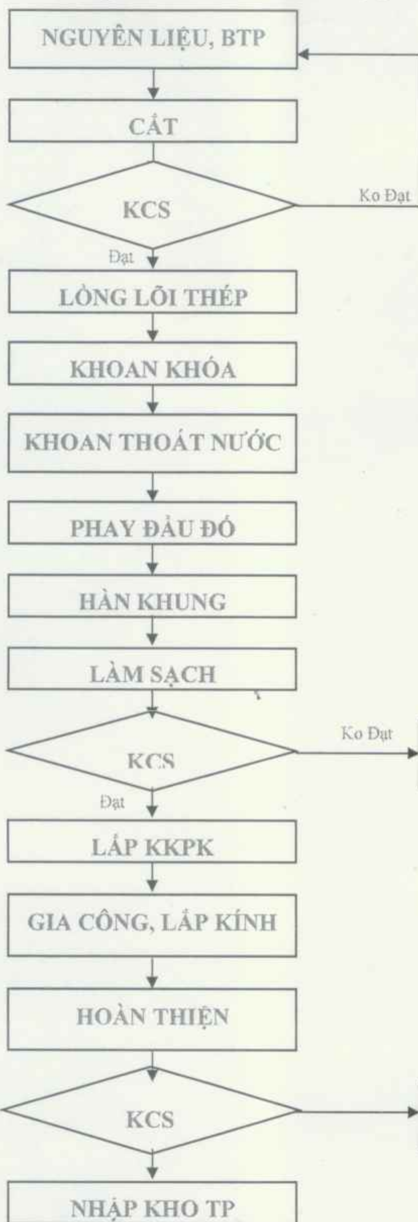
Quy trình sản xuất cửa uPVC có lõi thép
